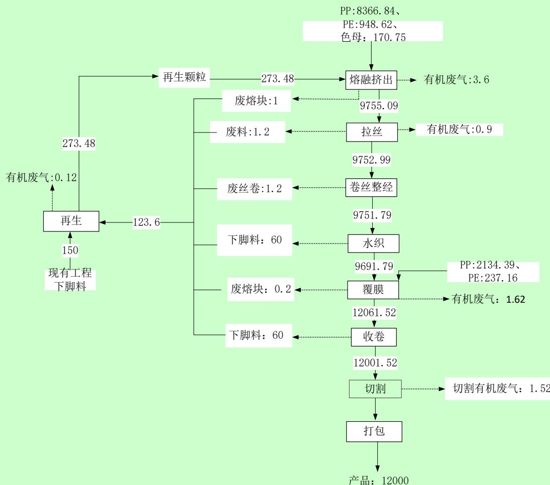
图 3.4-1 本项目生产物料平衡图（净重，不计包装物，单位 t/a）
